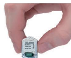
超小型のEllipse 2 Microは、-40～+85°Cの範囲でキャリブレーションされているため、あらゆる環境で一定の動作を提供します。モデルはEllipse2 Micro IMU、Ellipse2 Micro AHRS、Ellipse2 Micro INSの3種類。
